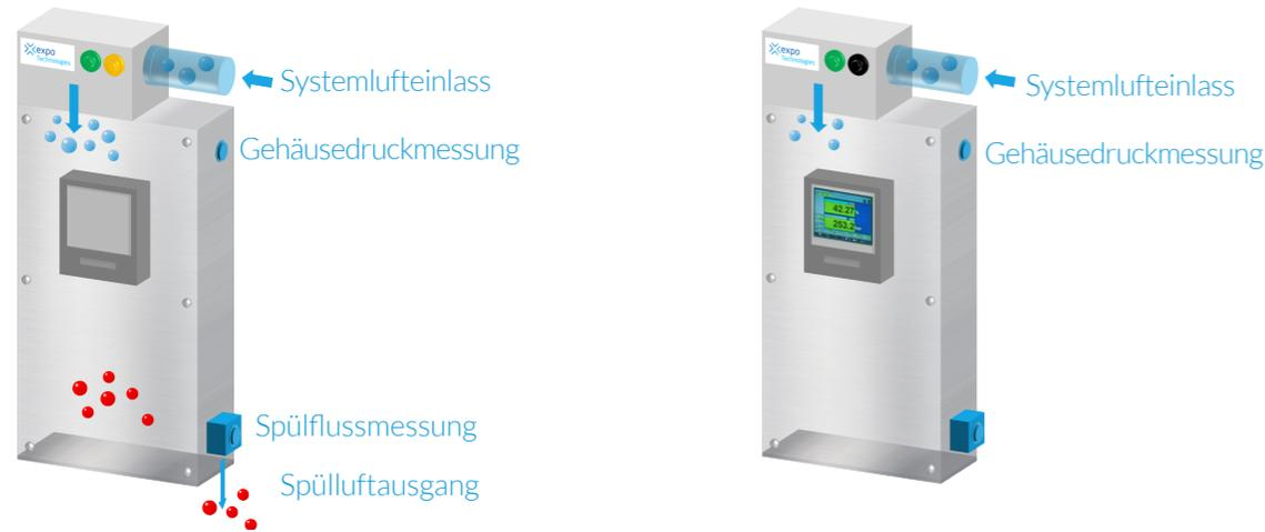
**Spülen:** Das Spülsystem bringt saubere, trockene Instrumentenluft in das Gehäuse, und zwar bei hoher Durchflussrate und für einen festgelegten Zeitraum. So wird die im Innern noch verbliebene, potenziell entflammbare Atmosphäre hinausgedrängt. Gehäusedruck sowie Spülfluss werden dabei kontrolliert. Der Gehäuseinhalt wird dabei nicht aufgeladen/in Gang gesetzt.
